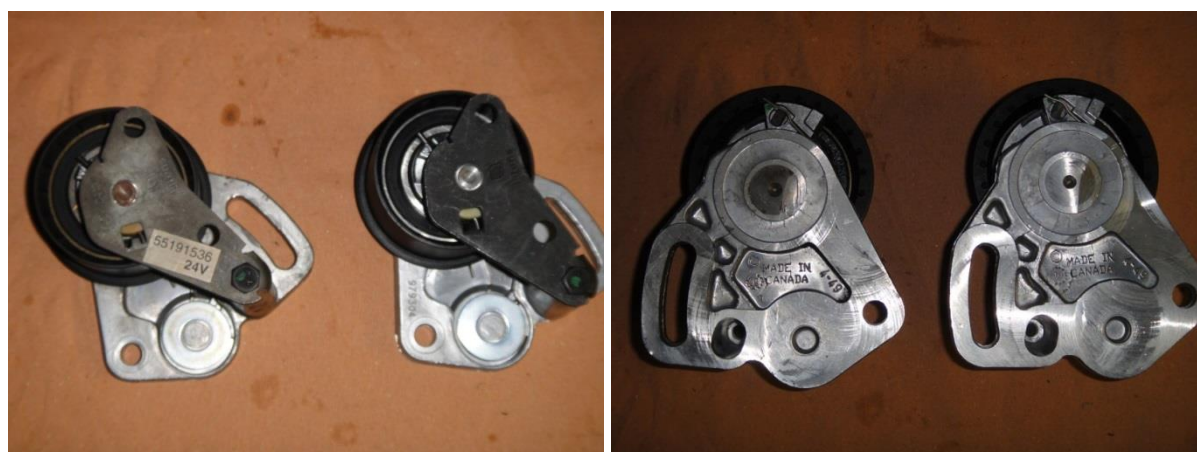
(Sur les photos : le tendeur Alfa à droite , et à gauche le Litens des kits Gates ou SKF)
